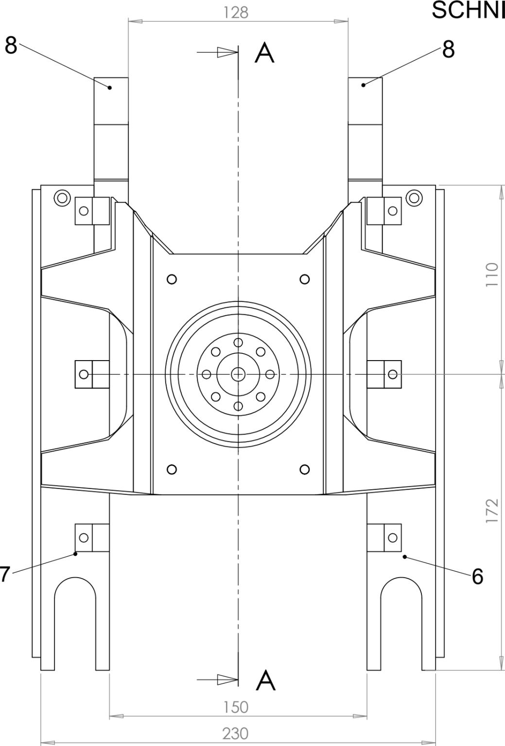
Diese Bohrung dient der Fixierung von BG2 Teil 001 nachdem die Antriebskette gespannt wurde
