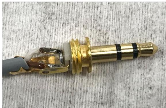
Nun kann der Werkzeuglängensensor einfach in die Klinkenbuchse der STEPCRAFT Steuerplatine eingesteckt werden.
