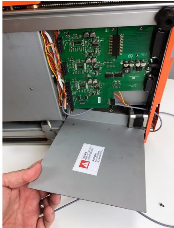
**Schritt 3** – Führen Sie das Kabel des Werkzeuglängensensors durch die Öffnung in der Rückplatte des STEPCRAFT CNC-Systems.
