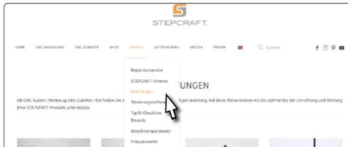
Folgen Sie diesem Link und laden Sie das Update für *WinPC-NC USB* herunter. Entpacken Sie das Archiv und verschieben es in den WinPC-NC-Installationsordner. Führen Sie die Datei *BLUpdate.exe* aus, um WinPC-NC für Ihre Fräsmaschine einzurichten. Starten Sie WinPC-NC.
